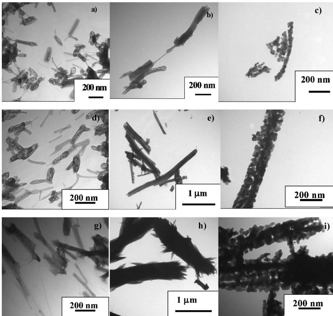
**Fig. 5** TEM images showing the effect of different molar ratio of 1,2-ethanediol (EG) and diethanolamine (DEA) on the morphological evolution of nano-arrays. Zn : Ox : EG : DEA 1 : 2 : 2 : 0 (a) Fresh gel, (b) Xerogel (80 °C), (c) Calcined (500 °C); Zn : Ox : EG : DEA 1 : 2 : 2 : 0.2, (d) Fresh gel, (e) Xerogel (80 °C), (f) Calcined (500 °C); Zn : Ox : EG : DEA 1 : 2 : 2 : 0.4, (g) Fresh gel, (h) Xerogel (80 °C), (i) Calcined (500 °C).
